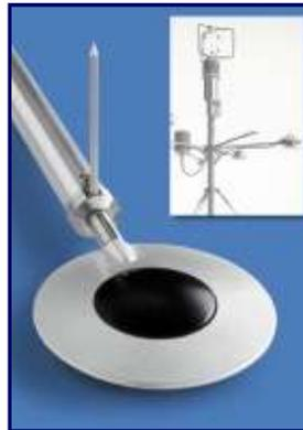
Per misurare quanto tempo, nell'arco di una giornata, il Sole è stato visibile al suolo in quanto non occultato da nubi, si impiega uno strumento detto eliofanografo.
