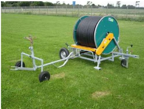
L'irrigatore semovente a nastro (rotolone) è costituito da un tubo flessibile avvolto in un tamburo dotato di un meccanismo di riavvolgimento.
